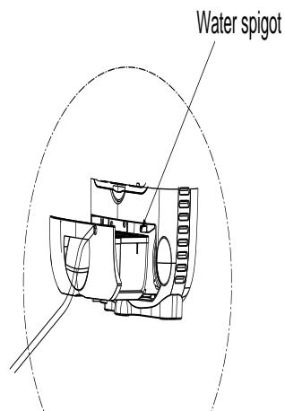
**Hvis ikke vannet renner ned slangen så sjekk at det er fall på den, at ikke slangen er ikke bøyd, at overflødig slange har blitt kuttet av og ikke er blokkert. Hvis vannet fremdeles ikke renner kan du lage et 4 mm hull, 20 mm ut fra luftavfukteren på toppen av slangen. Dette vil balansere ut lufttrykket og tillater vannet å strømme. Når du ikke lenger ønsker å bruke den permanente vannavløpet kobles dreneringsslangen fra enheten. Sørg for at vannbeholderen er plassert riktig.**
